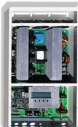
Interior de un inversor
